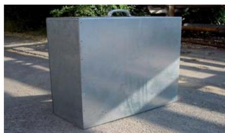
Schallschutzhaube für das Aggregat
